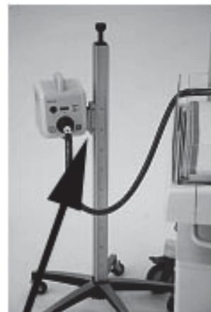
Вставляющаяся часть монтажного кронштейна (для направляющей «ласточкин хвост» и передвижного штатива).
