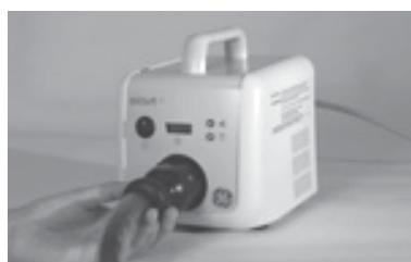
6. Вставьте оптоволоконный кабель в соединительное гнездо на корпусе.
